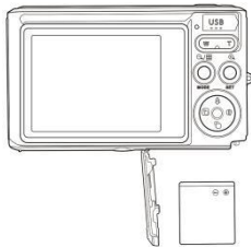
Lítium akkumulátor telepítése
