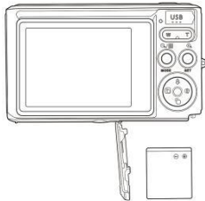
Batería de litio de instalación
